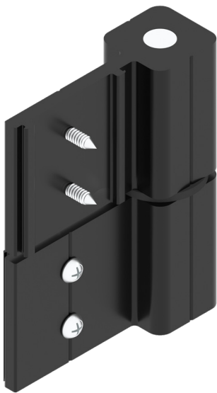
B2177000NE Bisagra libro Capacidad de carga: 2 bisagras 80 kg 3 bisagras 100 kg *considerando dimensiones de 1000 mm x 2400 mm*
