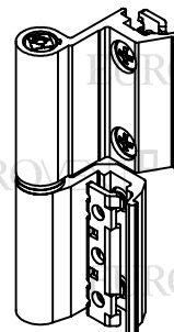
BISAGRA FLASH GN-451 PREMONTADA DERECHA CARACTERÍSTICAS: CAPACIDAD DE CARGA CON 2 BISAGRAS 75 KG. CON 3 BISAGRAS 85 KG. (CONSIDERANDO DIMENSIONES DE 1000 MM. x 2000 MM.)
