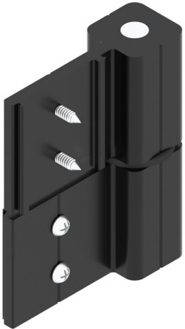
AC000701 B2177000NE* Bisagra libro Capacidad de carga: 2 bisagras 80 kg 3 bisagras 120 kg *considerando dimensiones de 1000 mm x 2300 mm*
